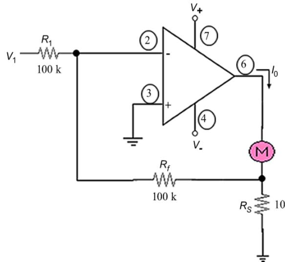
Figure 3.18 Op-amp dc Millivoltmeter
