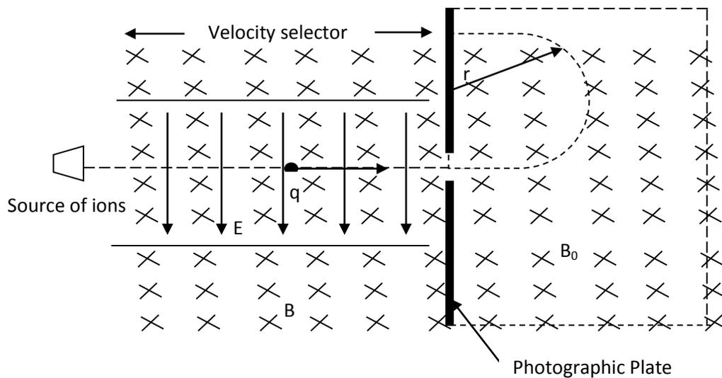
Fig. 2 Mass Spectrometer
