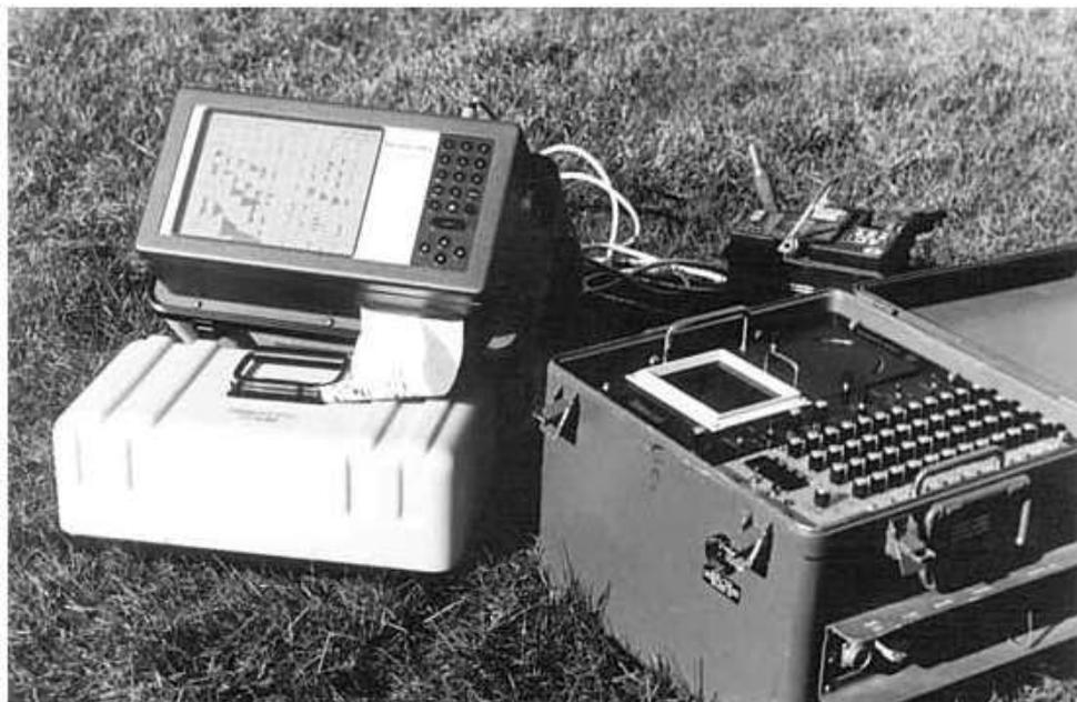
**Fig. 4.1:** Enhancement Seismographs
